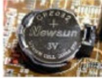
Figura 10: Batería del CMOS (BIOS)
